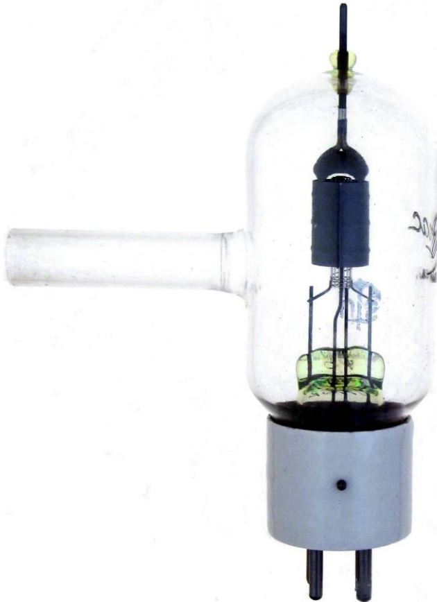
Triode ionization gauge
