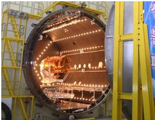
그림 11. 대형열진공챔버( \phi 8 \text{ m} \times \text{L}10 \text{ m} )
