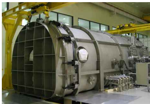
그림 12. 광학열진공챔버( \phi 4 \text{ m} \times \text{L}10 \text{ m} )
